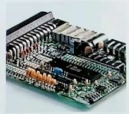
Die Elektronik der Fahrwerksdämpfung denkt mit. Ab 115 km/h schaltet sie bei „Komfort“-Einstellung automatisch auf „normal“.
