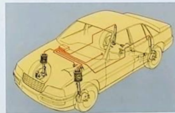
Kleine Stellmotoren in den Stoßdämpfern drehen entsprechend der Geschwindigkeit oder der manuellen Einstellung einen Kolben mit unterschiedlich großen Öffnungen.
