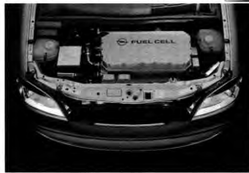
Wasser-Kraftwerk: Der HydroGen1 wird von einem Drehstrommotor angetrieben, den eine Brennstoffzelle speist
