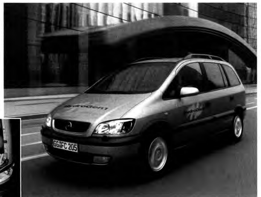
Wasser-Kraftwerk: Der HydroGen1 wird von einem Drehstrommotor angetrieben, den eine Brennstoffzelle speist
