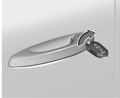
Die linke Vordertür durch Einsetzen und Drehen des Schlüssels im Schließzylinder von Hand verriegeln. Bei funktionierender Zentralverriegelung wird das Fahrzeug verriegelt
