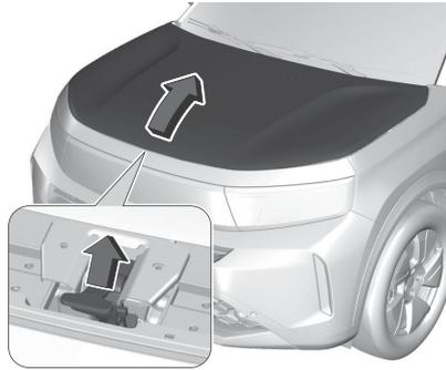
Heben Sie den äußeren Sicherheitsbügel an, und öffnen Sie die Motorhaube.
