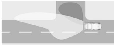
Beim Abbiegen werden je nach Lenkwinkel und Abbiegelicht bestimmte LEDs angesteuert, die die Fahrtrichtung beleuchten. Es ist bis zu einer Geschwindigkeit von 40 km/h aktiv.
