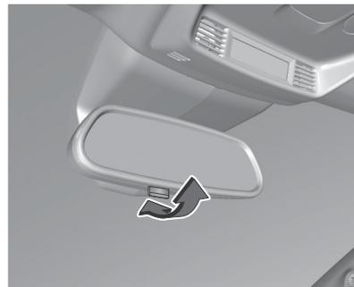
Zur Reduzierung der Blendwirkung, den Hebel an der Unterseite des Spiegelgehäuses ziehen.
