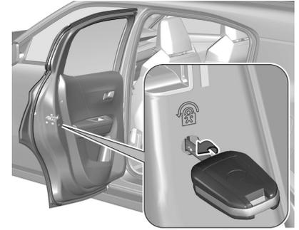
Rote Kindersicherung in den hinteren Türen mit einem Schlüssel in Richtung Fahrzeuginnenraum in die waagerechte Stellung drehen. Die Tür lässt sich dann von innen nicht öffnen.
