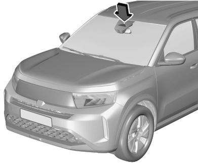
Windschutzscheibenaufkleber wie etwa Autobahnvignetten o.ä. nicht im Bereich des Innenspiegels anbringen. Sensor frei von Staub, Schmutz und Eis halten. Andernfalls könnten die Abtastzone des Regen-/Lichtensors und der Sichtbereich der Kamera im Spiegelgehäuse beeinträchtigt werden.
