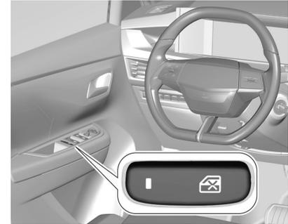
Zur Deaktivierung der elektrischen Fensterheber der hinteren Türen die Taste drücken. Die LED leuchtet auf. Zur Aktivierung, erneut drücken.
