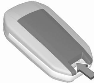
1. Um die Abdeckung zu lösen, führen Sie einen kleinen Schraubendreher zwischen der hinteren Abdeckung und der Fernbedienung ein.
