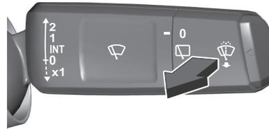
Den Hebel ziehen. Waschflüssigkeit spritzt auf die Windschutzscheibe und der Wischer wird für einige Wischbewegungen eingeschaltet.
