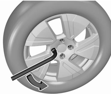
2. Radschlüssel anbringen und jede Radschraube um eine halbe Umdrehung lockern.
