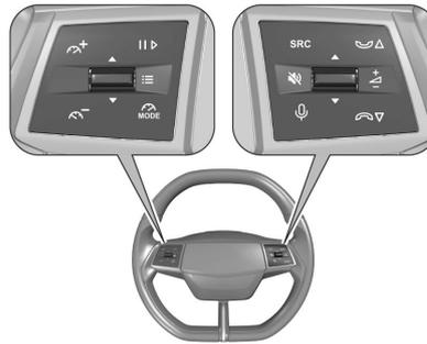
Bestimmte Fahrerassistenzsysteme, das Infotainment-System und ein verbundenes Mobiltelefon können über die Bedienelemente am Lenkrad bedient werden.
