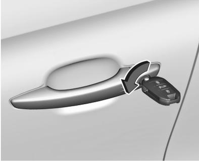
Die linke Tür durch Einsetzen und Drehen des Schlüssels im Schließzylinder entgegen den Uhrzeigersinn von Hand entriegeln.
