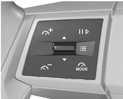
Das **MODE**-Symbol einmal drücken, um die Geschwindigkeitsregelungsfunktion zu aktivieren.
