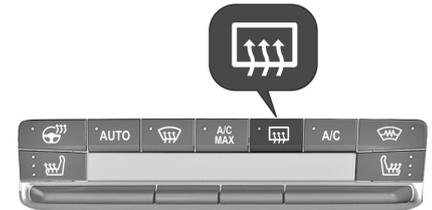
Drücken Sie die Taste zum Aktivieren der Funktion. Abhängig von den Außentemperaturen wird die Heizung nach einer bestimmten Zeit automatisch ausgeschaltet.
