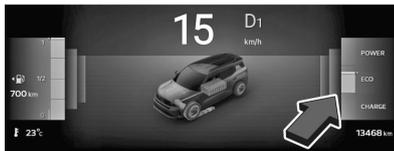
Die Leistungsanzeige gibt Auskunft über den aktuellen Energiezustand des Fahrzeugs.
