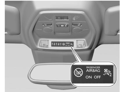
Wenn die Kontrollleuchte ON nach Einschalten der Zündung für ca. 60 Sekunden aufleuchtet, löst der Beifahrer-Airbag bei einem Unfall aus.
