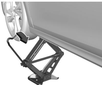
Das Fahrzeug mit korrektem ausgerichtetem Wagenheber anheben, bis das Rad vom Boden abhebt.
