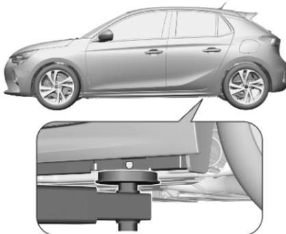
Die Position der hinteren Arme der Hebebühne befindet sich mittig unter den entsprechenden Wagenheberaufnahmen.
