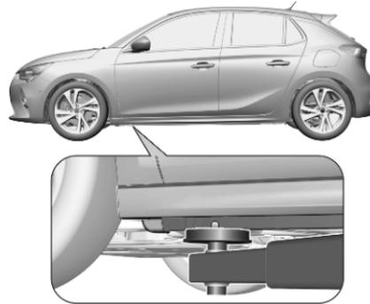
Die Position der vorderen Arme der Hebebühne befindet sich mittig unter den entsprechenden Wagenheberaufnahmen.
