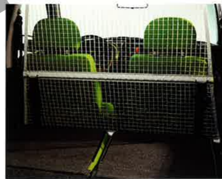
Ein Sicherheitsnetz, hinter Fahrer- und Beifahrersitz montiert, verhindert das Eindringen von Ladegut in den Fabrgastraum (voraussichtlich lieferbar ab Herbst 2000).
