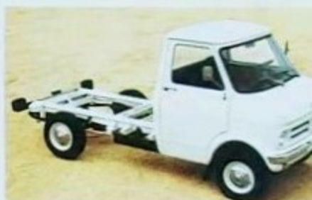
Fahrgestell mit Fahrerhaus, kurzer Radstand: 2692 mm, Gesamtgewichte: 2340, 2540, 2740 kg.
