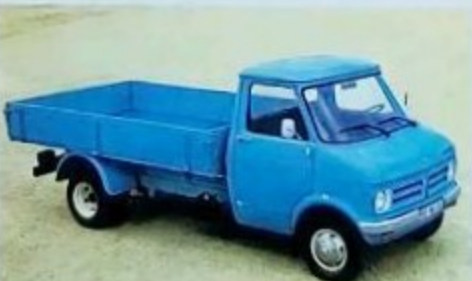
Pritschenwagen, langer Radstand: 3200 mm, Zwillingbereifung, Gesamtgewicht: 3500 kg.
