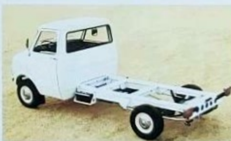
Fahrgestell mit Fahrerhaus, langer Radstand: 3200 mm, Gesamtgewicht: 2800 kg.
