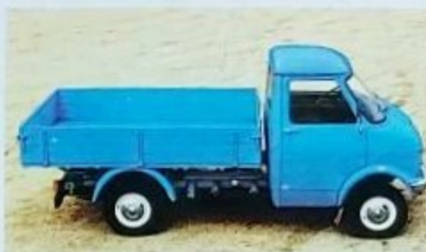
Pritschenwagen, kurzer Radstand: 2692 mm, Gesamtgewichte: 2340, 2540, 2740 kg.
