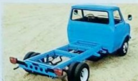
Fahrgestell mit Fahrerhaus, langer Radstand: 3200 mm, Zwillingbereifung, Gesamtgewicht: 3500 kg.
