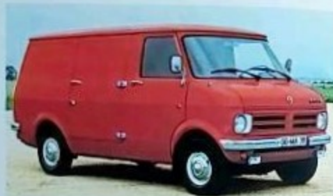
Kastenwagen, kurzer Radstand: 2692 mm, Gesamtgewichte: 2340, 2540 kg.
