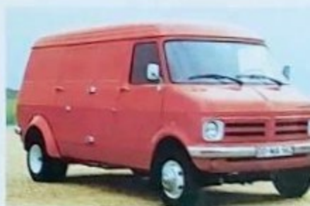
Kastenwagen, langer Radstand: 3200 mm, Zwillingbereifung, Gesamtgewicht: 3500 kg.
