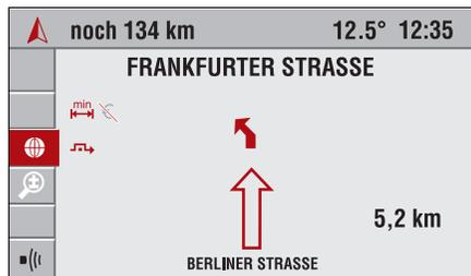
Zusätzlich wird über dem Richtungspfeil ein vereinfachter Vorhinweis dargestellt, der Sie bereits in größerer Entfernung über die nächste Fahrtrichtungsänderung informiert.
